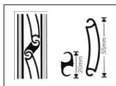
Οδηγός από γαλβανιζέ χάλυβα πάχους 1,5 - 2mm σε σχήμα "Ω" που συνεργάζεται με ειδικό προφίλ αλουμινίου και βουρτσάκι για μείωση τριβών και θορύβων.
